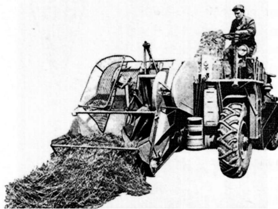
Maschinenträger MT 160 mit aufgesattelter Hochdruckpresse
